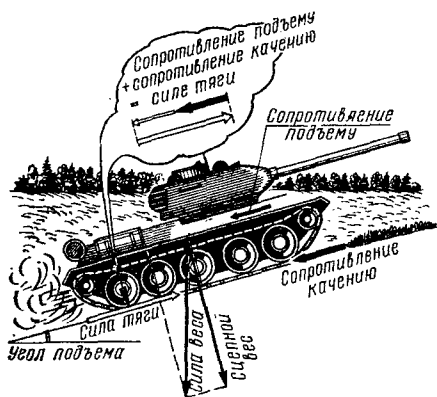
Рис. 154. Силы, действующие на танк при движении на подъеме
